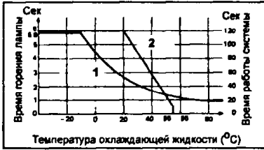
(2С). 1 - время горения лампы, 2 - время работы системы.
